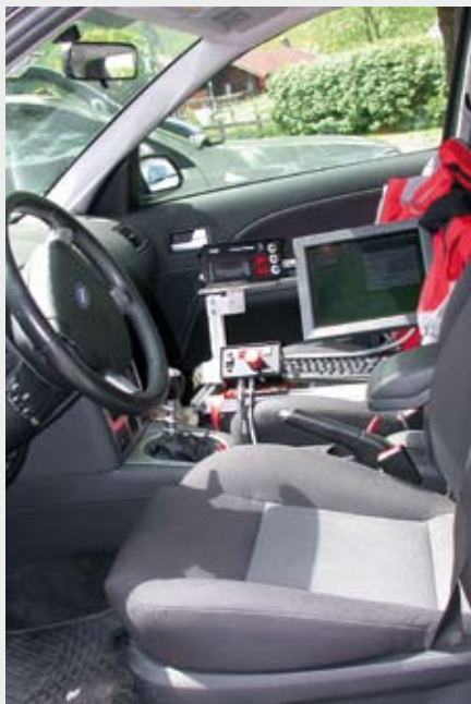
Dodatkowe wyposażenie: W testowym aucie zainstalowany był cały zestaw urządzeń do monitorowania pracy hamulców.
