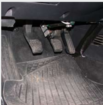
Dokładny pomiar: Czujniki były zainstalowane pod pedałami i oczywiście przy samych zaciskach.
