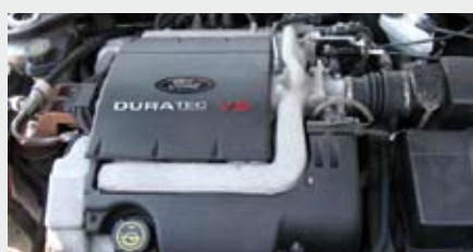
Wersja benzynowa 2.5 V6 - rozwinięcie jednostki stosowanej w starszej generacji Mondeo.
