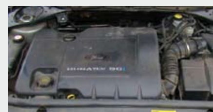
Unikalny silnik 1.8 SCi z bezpośrednim wtryskiem benzyny.
