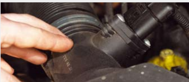
Przepływomierze - słynna już, ale na szczęście uleczalna słabość silników wysokoprężnych TDi.
