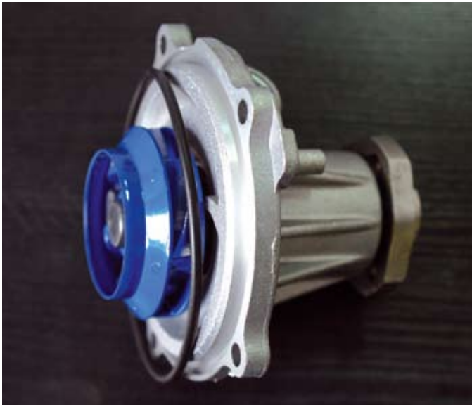
Pompa cieczy do wersji 1.9 TD napędzana jest kółkiem pasowym od paska osprzętu.
