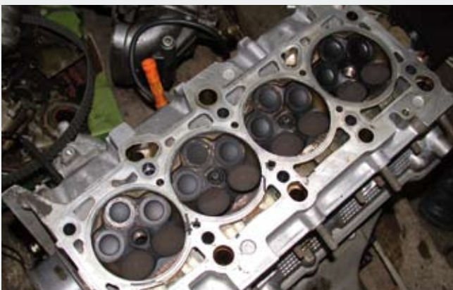
W silnikach 1.8 oraz 1.8 T na każdy cylinder przypada aż 5 zaworów co podnosi koszty naprawy głowicy.
