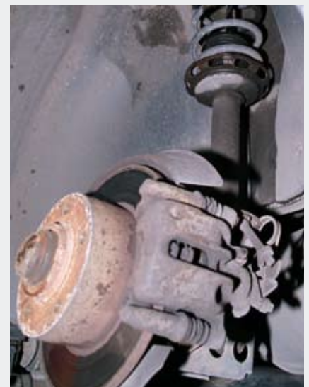
Tylne tarcze, widok od tyłu. Widać zespół hamulca pomocniczego.
