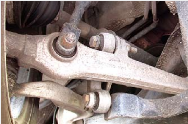
Producent zaleca wymianę całego kompletu wahaczy - wymiana pojedynczych elementów nie zawsze się sprawdza.
