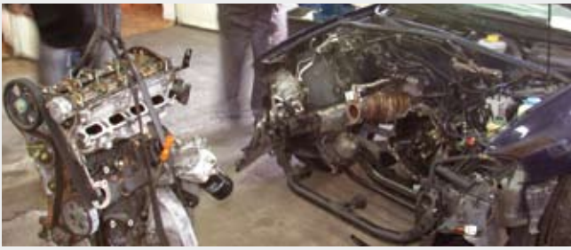
Demontaż przedniego pasa konieczny jest nie tylko przy wyciąganiu silnika, ale także przy wymianie rozrządu.
