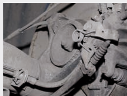
Tylne tarcze, widok od tyłu. Widać pierścień do abs oraz układ hamulca pomocniczego.
