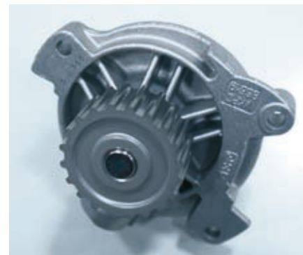
Pompa cieczy do wersji 2,4 oraz 2,5 TDi napędzana jest od paska zębatego rozrządu.
