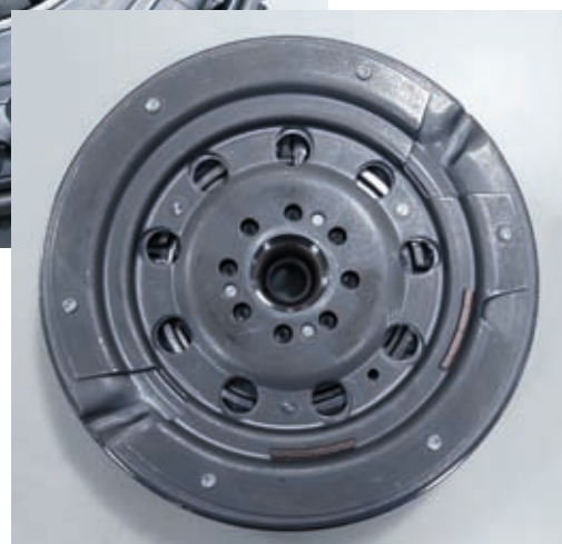
Przykładowy zestaw LUK, numer ref.: 417000811: Dwumasowe koło zamachowe razem z kompletem sprzęgłowym.
