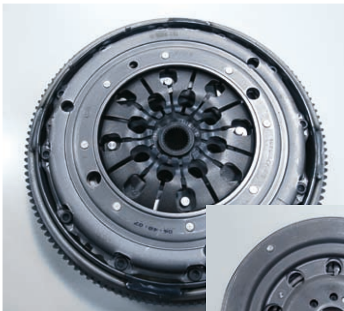
Przykładowy zestaw LUK, numer ref.: 417000811: Dwumasowe koło zamachowe razem z kompletem sprzęgłowym.
