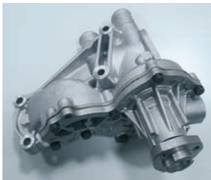
Pompa cieczy do wersji 1.9 TD napędzana jest kółkiem pasowym od paska osprzętu.
