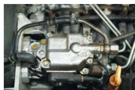
Elektronicznie sterowana pompa wtryskowa może odmówić posłuszeństwa przy eksploatacji na oleju opałowym.
