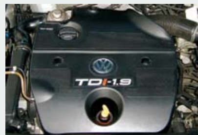
Czerwona literka I oznacza TDi 110 KM z pompą rotacyjną i zmienną geometrią łopatek turbiny.
