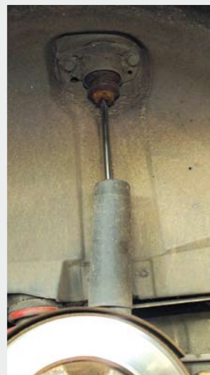
AMORTYZATORY TYLNE: Tylony amortyzator osadzony jest w dość oryginalny sposób, dzięki czemu łatwo go wymontować, bez konieczności wchodzenia do bagażnika czy pod tylną kanapę. Na zdjęciu wersja z przednim napędem.
