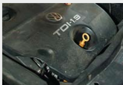
Podstawowa wersja 1.9 TDi - z pompą rotacyjną i bez zmiennej geometrii łopatek turbiny.
