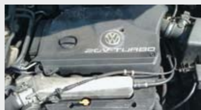
1.8 20 V Turbo , ma jeden pasek rozrządu i jeden łańcuch łączący dwa wałki rozrządu.
