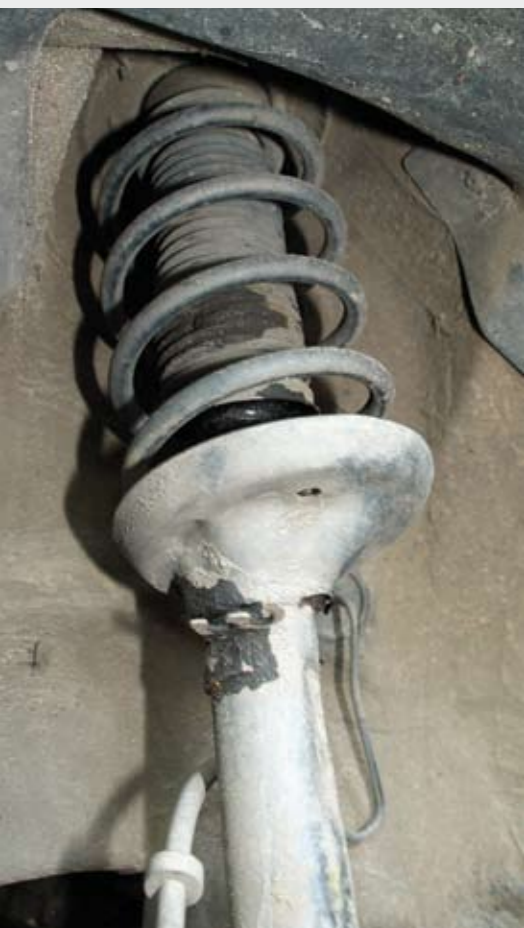
AMORTYZATORY PRZEDNIE: Amortyzatory przednie wymienia się jako całość, razem z kolumną.
