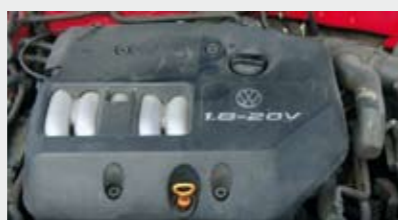
1.8 20 V , ma jeden pasek rozrządu i jeden łańcuch łączący dwa wałki rozrządu.
