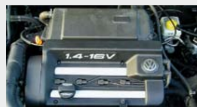
1.4 16 V , ma dwa paski rozrządu. Jeden łączy wałek rozrządu i wał korbowy, a drugi oba wałki.
