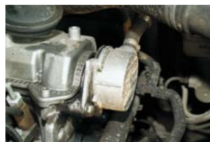
Pompka odpowiedzialna za wytwarzanie podciśnienia w serwie układu hamulcowego znajduje się tuż przy dekle zaworowym.
