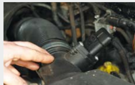
Przepływomierz - słaby punkt wszystkich TDi
