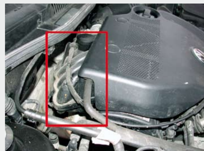
Pompka odpowiedzialna za wytwarzanie podciśnienia w serwie układu hamulcowego znajduje się tuż przy dekle zaworowym.
