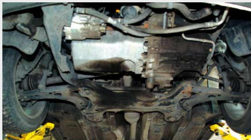
Przednie zawieszenie Golfa IV powstało w oparciu o kolumny McPhersona. Uwagę zwraca solidna rama pomocnicza.
