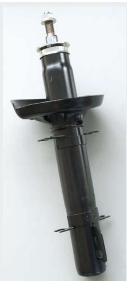
AMORTYZATORY PRZEDNIE: Amortyzatory przednie wymienia się jako całość, razem z kolumną.
