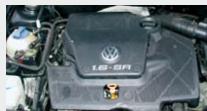
1.6 8 V , ma jeden wałek rozrządu i jeden pasek zębaty.
