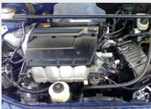
Dla porównania: 2.0 16V (Sprzed liftingu) Pasek rozrządu, hydraulika zaworowa. Tradycyjny, pośredni wtrysk benzyny.
