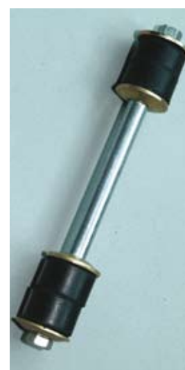
Oryginalny, prosty łącznik stabilizatora - widok w samochodzie, oraz widok na nową część zamienną.
