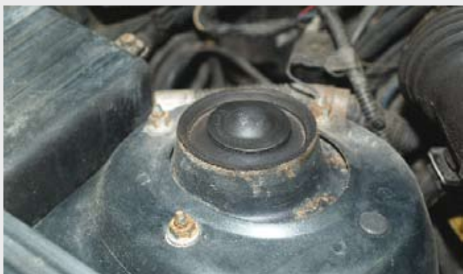
Poduszka z łożyskiem mocująca kolumnę McPherson
