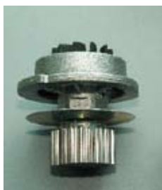
Pompa do wersji 16 - zaworowych ma metalowy tarczyk pod kołem pasowym.
