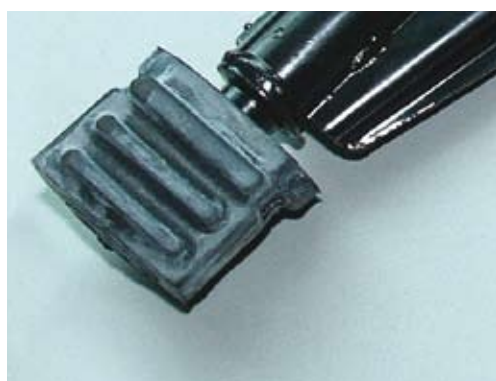
Wymienny element metalowo gumowy - tuleja wahacza przednia
