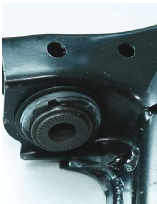
Wymienny element metalowo gumowy - tuleja wahacza tylna
