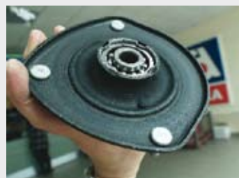
Poduszka z łożyskiem mocująca kolumnę McPherson
