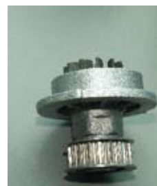
Pompa do wersji 8 - zaworowych jest nieco mniejsza
