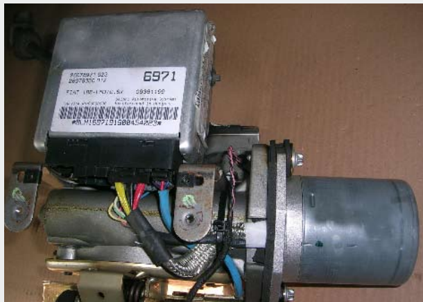
Zespół elektrycznego wspomagania kierownicy. Używane kosztują ok. 400 zł. Psują się głównie w naukach jazdy (plac manewrowe).
