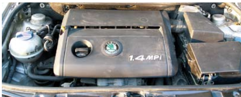
Bazowy silnik 1.4 bazuje na jednostce 1.3 z Felicii, i posiada dolny wałek rozrządu.
