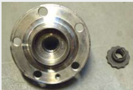
Zestaw naprawczy piasty przód (20 zębów) SKF: VKBA 3568 FAG: 713610580
