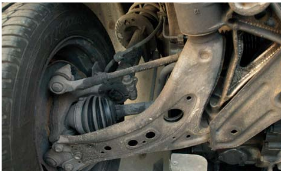
Przednie zawieszenie Fabii to układ McPherson.
