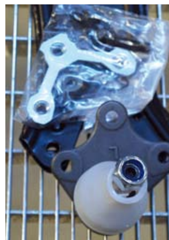
Sworznie są przykręcane do wahacza. Możemy dokupić je oddzielnie.
