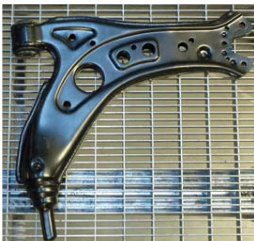
Sworznie są przykręcane do wahacza. Możemy dokupić je oddzielnie.
