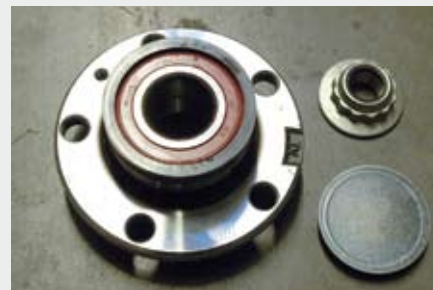
Zestaw naprawczy piasty tył SKF: VKBA 3567 FAG: 713610490
