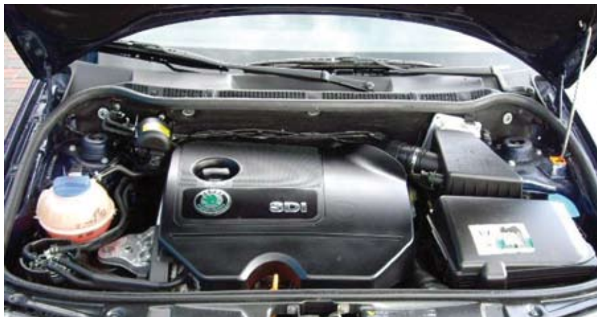
Bazowy silnik wysokoprężny 1.9 SDI - jest wtrysk bezpośredni, brak turbodoładowania.
