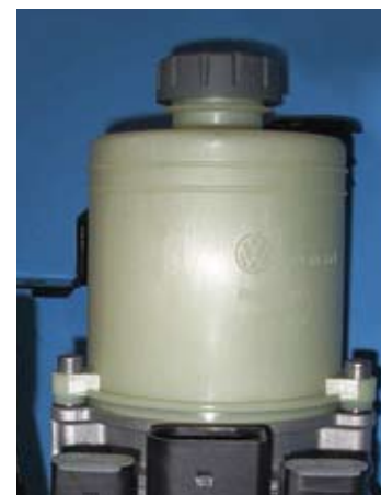
Wspomaganie układu kierowniczego - Objętość - 0,8l. Płyn Pentosin CHF 11S/202
