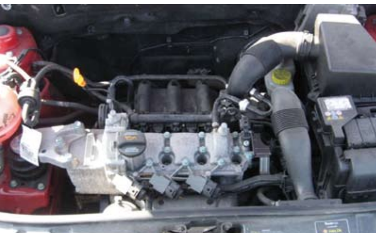
Najmniejszy dostępny w Polsce silnik ma pojemność 1198 ccm i tylko trzy cylindry. Na każdy przypada jedna cewka zapłonowa.
