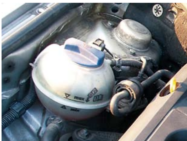
Pojemność układu chłodzenia - 5,0 - 6,9 litra. Dopuszczalne wyłącznie płyny do chłodzić aluminiowych.
