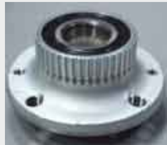
Przykład piasty tylnej z ABS (VKBA 3442) z zębatego koła układu ABS (Nowszy typ).
