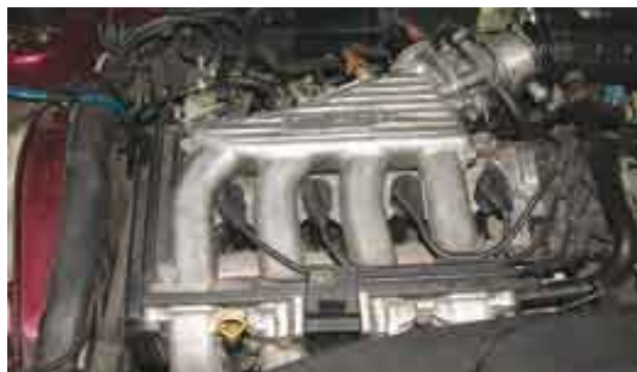
Najbardziej popularny - 1.6 16V. Co ciekawe - występuje zarówno z plastikowym (u góry) jak i metalowym (u dołu) kolektorem ssącym.
