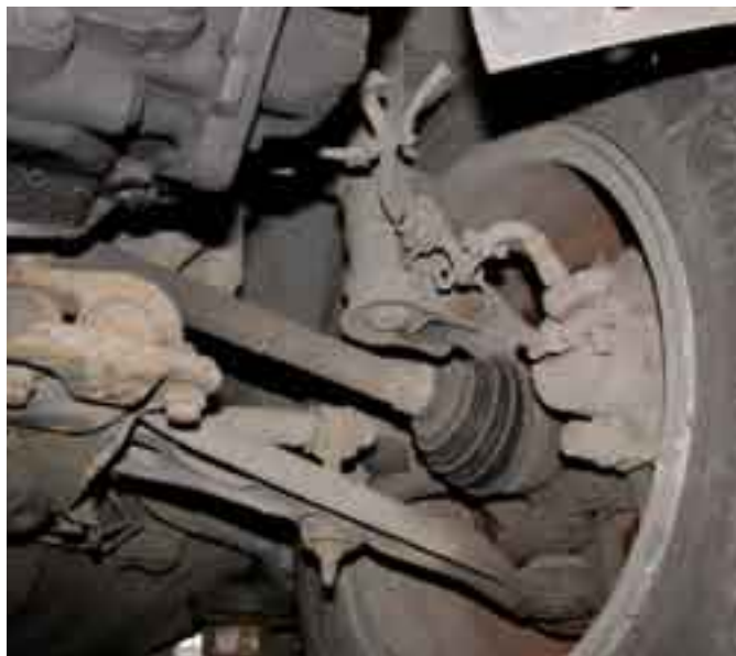
Przednie zawieszenie BRAVO i BRAVA jest identyczne - powstało w oparciu o kolumny McPhersona i wahacze trójkątne.
