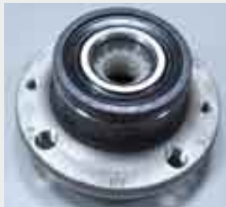
Przykład piasty tylnej z ABS (VKBA 3540). Bez zębatego koła (starszy typ).
