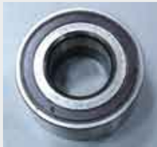
Przykład łożyska przedniego z ABS (VKBA 3538). Widoczny czarny pierścień jest magnetyczny i należy montować go odpowiednią stroną do czujnika.
