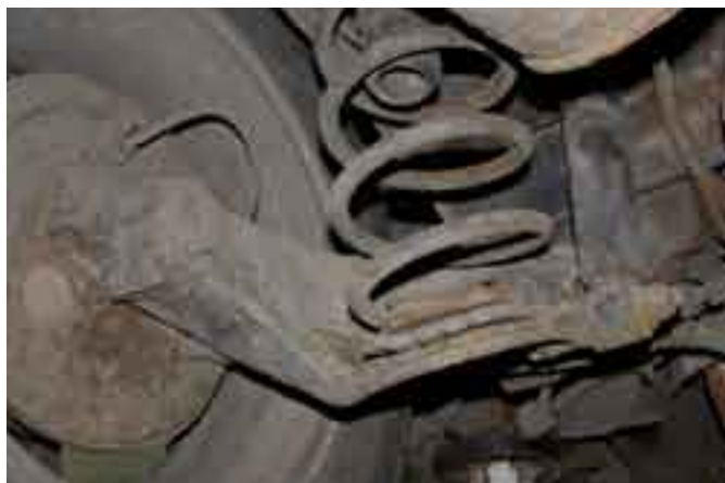
Przednie tylne BRAVO i BRAVA jest identyczne. Niezależna konstrukcja ma po jednym wahaczu na każde koło.
