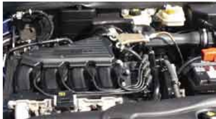
Najbardziej popularny - 1.6 16V. Co ciekawe - występuje zarówno z plastikowym (u góry) jak i metalowym (u dołu) kolektorem ssącym.
