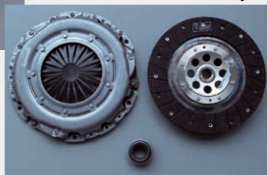
Sprzęgło LUK 623 31 99 00 (2.0 HDi 107 KM, współpracuje z dwumasowym kołem zamachowym)
