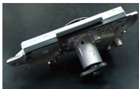
Pompa ciecży KWP 10931 do benzynowego silnika 1.5 16 V - uwagę zwraca charakterystyczne uszczelnienie.
