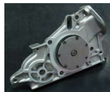
Pompa ciecży KWP 10931 do benzynowego silnika 1.5 16 V - uwagę zwraca charakterystyczne uszczelnienie.
