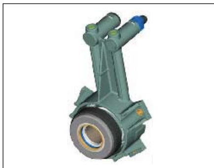
Fot. 1: Centralny wysprzęglik z oddzielnym odpowietrzeniem
